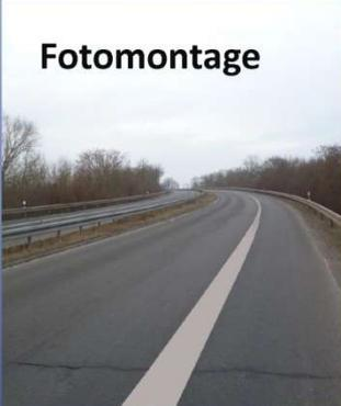
Ummarkierung der Auheimer Straße von vier Fahrspuren auf zwei breite Fahrspuren und zwei Mehrzweckstreifen
